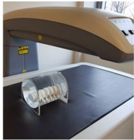
그림 6. DEXA 스캔을 위한 Spine phantom 세팅
