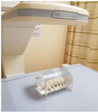
그림 6. DEXA 스캔을 위한 Spine phantom 세팅
